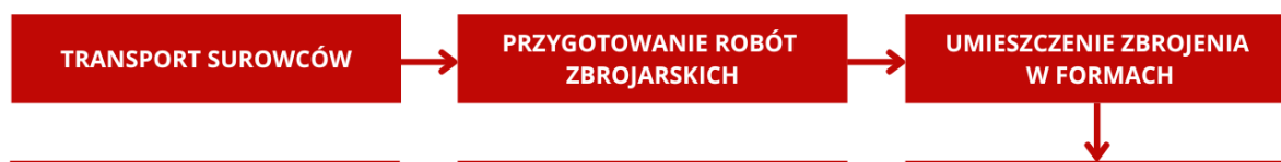
Rysunek 5.2 : Schemat procesu produkcji ścian oporowych
